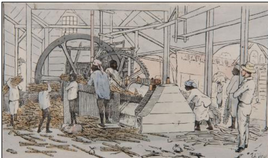
Afbeelding 6. Het interieur van een suikerrietfabriek op een plantage waarbij het riet gekneusd wordt.
